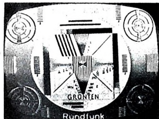
Schirmbild des Fernsehempfängers bei falsch justiertem Ionenfallenmagneten
